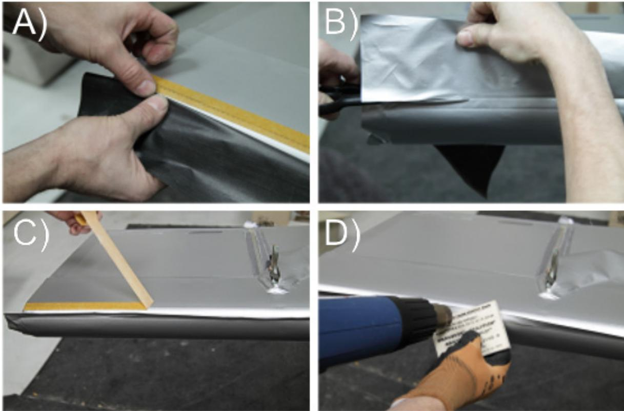
A) Um eine genaue Schnittlinie zu erhalten, kleben Sie das Montageband mit 1 mm Untermaß dort entlang wo Sie ihre Schnittlinie enden lassen wollen. Knicken Sie das Gewebe im Abstand von einem 1 mm zum Rand der Montageband-begrenzung. Es entsteht eine Falzkante, an der man sauber schneiden kann.
