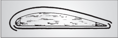
(4) Tragseitenunterfläche zuerst bespannen
