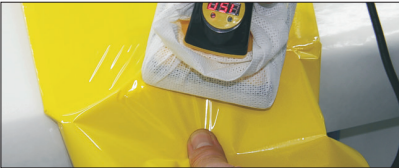
(9a) Arbeiten Sie langsam um Rundungen
