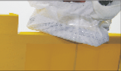
(12b) die Bespannung um die Leiste legen und verbügeln
