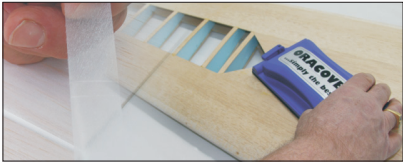
(2) Strukturoberfläche glatt verschleifen
