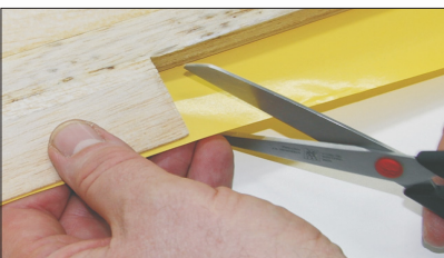
(12a) innere Ecken mit 45° einschneiden
