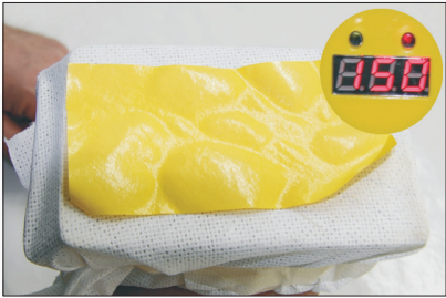
(3b) Temperaturtest bei 150 °C / 260 °F
