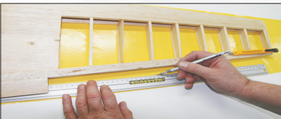
(10a) Beschnitt ab den Querruderaussparungen
