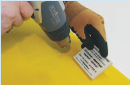
Abb. 9b Abschlussschrumpfung
