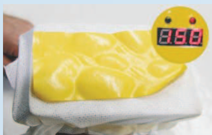
Abb. 3C Temperaturtest bei ca. 150 °C
