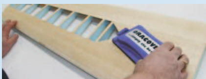
Abb. 2 Abschleifen der Oberfläche
