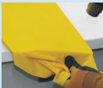
Abb. 11a-d Bespannung des Randbogens
