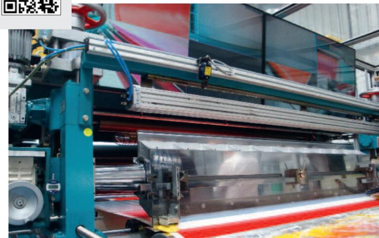
Eine hochmoderne und vollautomatische Fertigungsstraße trägt Klebstoff und Farbe auf die Folienrollen auf. Die Bestandteile werden automatisch zugeführt. Obwohl die Arbeitsprozesse automatisch ablaufen, gibt es eine Vielzahl von manuellen Kontrollmöglichkeiten. Hierzu sind Anlagentechniker ständig vor Ort und überwachen die Produktionsabläufe. Am Ende werden die Rollen wieder gewickelt und warten im Lager auf ihre Weiterverarbeitung.
