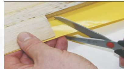
(12a) innere Ecken mit 45° einschneiden
