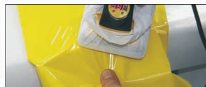
(9a) Arbeiten Sie langsam um Rundungen
