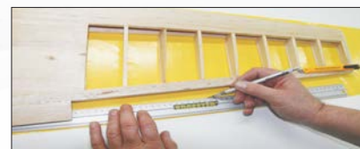
(10a) Beschnitt ab den Querruderaussparungen
