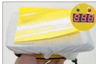
(3a) Temperaturtest bei 90 °C / 194 °F
