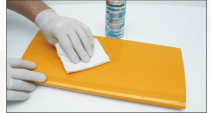
Vor dem Lackieren / Spritzen mit ORACOLOR®-Verdünnung reinigen.
