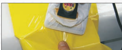
(9a) Arbeiten Sie langsam um Rundungen
