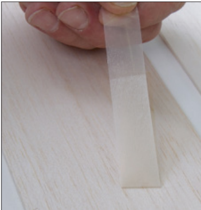
Klebkrafttest mit Selbstklebeband
