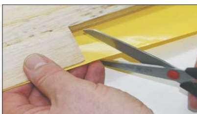
(12a) innere Ecken mit 45° einschneiden
