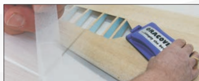
(2) Strukturoberfläche glatt verschleifen
