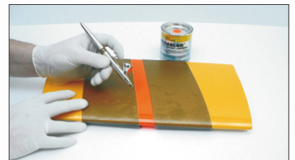
Nach dem letzten Lackiergang die EASYPLOT® Schablonierfolie sofort entfernen.
