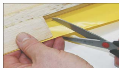
(13a) innere Ecken mit 45° einschneiden
