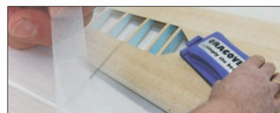
(2) Strukturoberfläche glatt verschleifen
