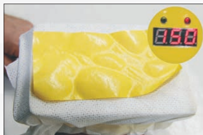
(3b) Temperaturtest bei 150 °C / 260 °F
