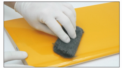
ORACOVER® kann mit „000“ Stahlwolle aufgeraut werden. VOR dem Aufrauhern mit Entfetter (Nr. 08245) reinigen.
