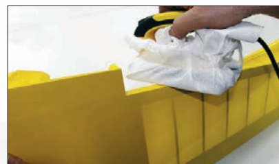
(13b) die Bespannung um die Leiste legen und verbügeln
