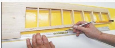
(12a) Beschnitt ab den Querruderaussparungen
