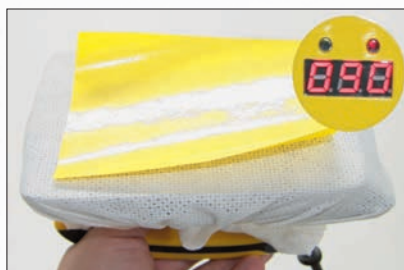
(3a) Temperaturtest bei 90 °C / 194 °F
