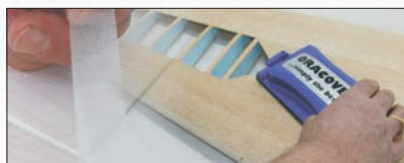
(2) Strukturoberfläche glatt verschleifen
