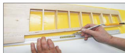
(10a) Beschnitt ab den Querruderaussparungen
