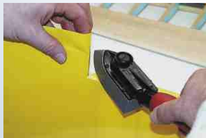
Zdj. 12b - potem owinąć i naprasować
