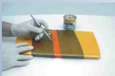
Po ostatnim lakierowaniu folii EASYPLOT® natychmiast usunąć folie szablonową.
