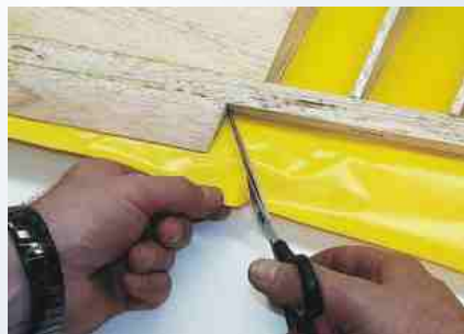
Zdj. 12a - Przy rogach naciąć na wewnętrznej stronie pod kątem 45°
