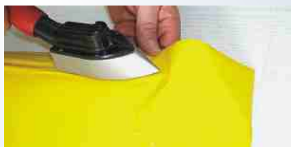
Zdj. 9/9a - Stopniowo prasować wokół łuku na krawędzi
