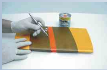
イージプロット型抜きフィルムを塗装の最後に直ちに剥がす。
