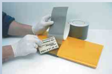
イージプロット型抜きフィルムをフェルトブレード (注文No. 0915) で、バブルが出来ないようにする。
