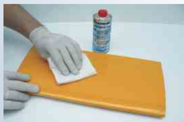
ラッカー塗装/スプレーの前にオラカラー・シンナーでクリーニング
