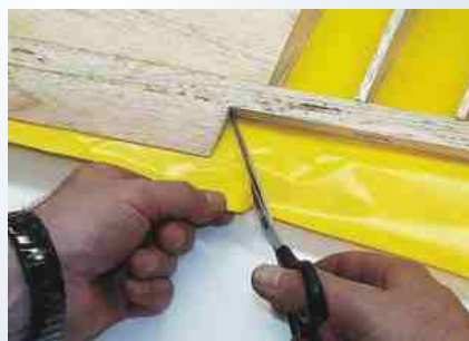
図12a 内側の角をまず45度で切る
