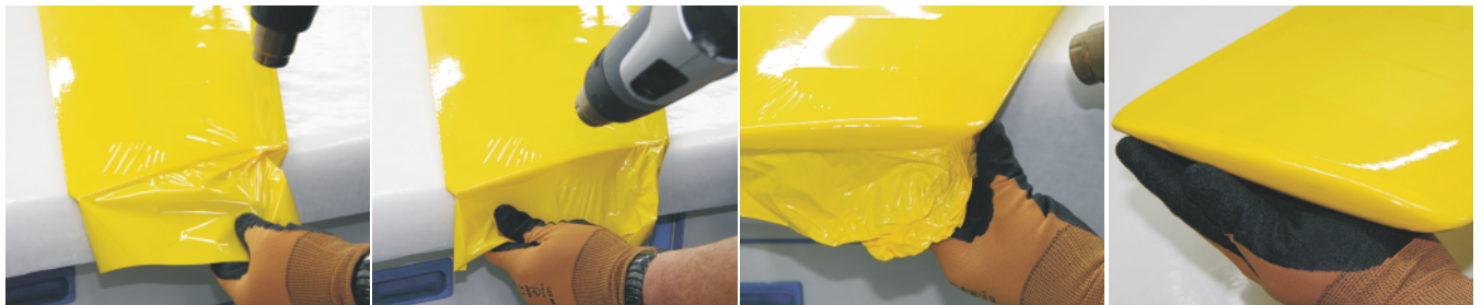
Abb. 11a-d Bespannung des Randbogens
