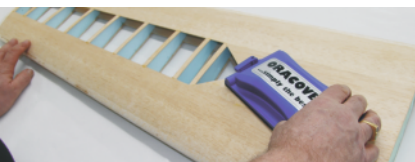
Abb. 2 Abschleifen der Oberfläche
