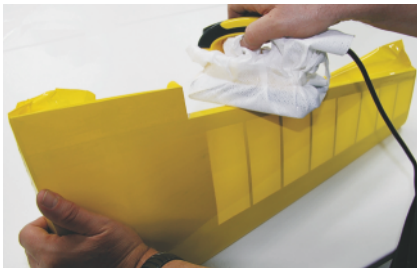
Abb. 12b Nach dem Einschneiden umschlagen und festbügeln.
