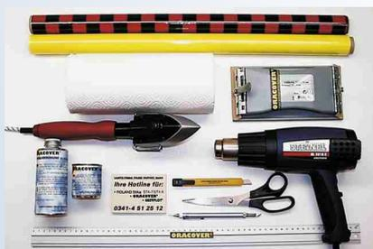
Fig. 1 Outils nécessaires pour la pose
