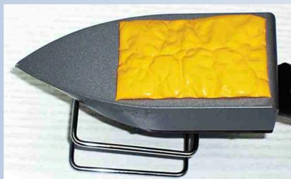
Fig. 3C Test de température du fer a 150 °C
