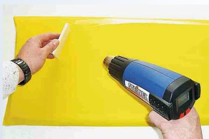
Fig. 9b Tension finale de l'entoilage
