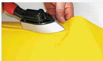
Fig. 9 / 9a Entoilage des formes développées
